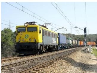
es un vehículo ferroviario que cuenta con todos los sistemas necesarios para realizar tanto la tracción como el frenado de los trenes. Los vagones o coches no poseen tracción, aunque si sistemas de freno accionados simultáneamente con los de la locomotora. Los sistemas tipo tren puede contar con gran número de vagones (composiciones de 700 metros), estar dotados de más de una locomotora traccionando a la vez (doble, triple, etc.) e incluso contar con tracción en cola.
