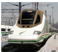
Vehículo ferroviario, normalmente especializado en el transporte de viajeros, que se caracteriza por disponer de dos cabinas de conducción y por sistemas de tracción y control que están ubicados en arcones colgando del bastidor, de forma que todo el volumen por encima del mismo está destinado al transporte de viajeros.
